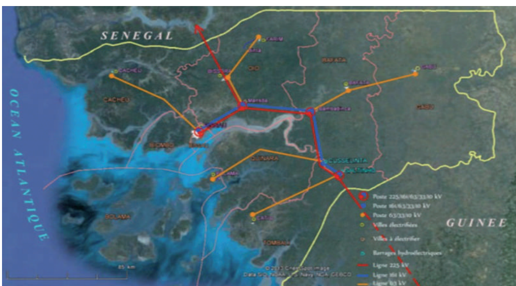
Figura 27 Futura linha OMVG e rede eléctrica nacional / Fonte: SEforALL IP, 2017
